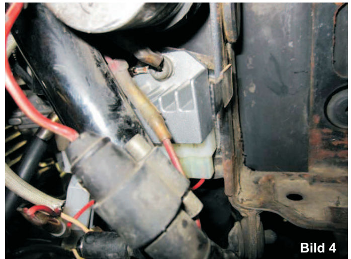
neuer Regler fertig montiert
